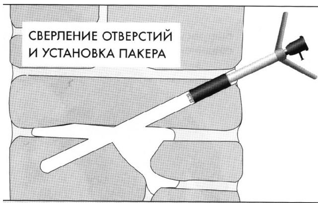
Рис.37. Закрепление пакеров в конструкциях:
